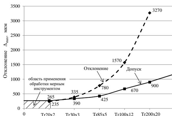
Рис. 5 – Область применения мерного инструмента при обработке трапецидальной резьбы
