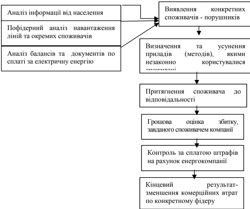
Рис. 2 - Схема виявлення точок безоблікового користування у споживачів
