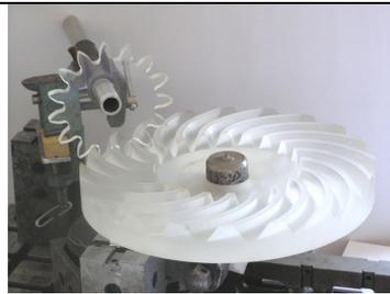
Рис. 7. Прототип цилиндрично-конической двухпараметрической зубчатой передачи
