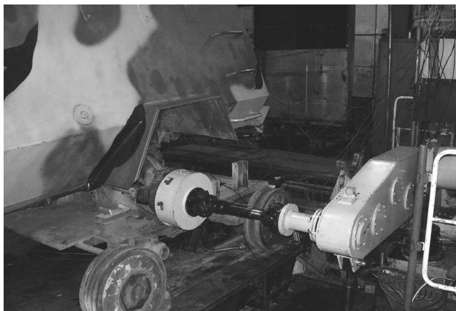
Рис.7. Подключение входного вала суммирующего редуктора к ступице заднего колеса броневедомого автомобиля
