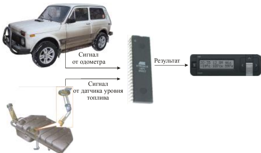
Рисунок 3 – Функциональная схема многофункционального цифрового измерителя количества и расхода топлива
