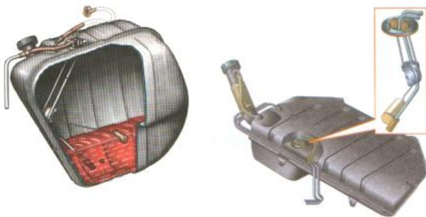
Рисунок 6 – Форма топливного бака автомобилей ВАЗ 2104–07 и ВАЗ 2121
