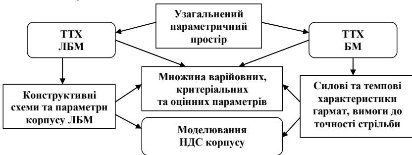
Рисунок 3 – Тактико-технічні характеристики бойової машини в системі формування оціночних критеріїв конструкції корпусу легкоброньованої машини і характеристик бойового модуля
