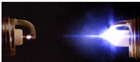
Рис. 5. Сравнение вида искры, формируемой на обычной свече (слева), с искрой на свече Pulse Plug [8]
