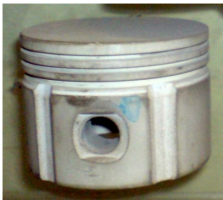
Рисунок – Поршень с продольными канавками
