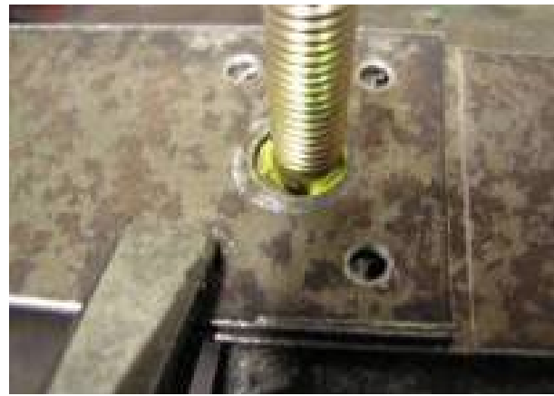
Рис. 7 – Разобранный болтовой крепеж с выбранным зазором
