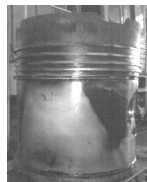
Рис. 12 – Поршень з корундовим шаром дизеля тепловоза ЧМЕ–3: а – до випробувань, б – після напрацювання 114676 мотогодин
