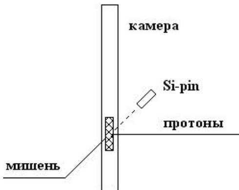
Рис.1 – Расположение Si-pin детектора относительно пучка протонов и камеры с образцами
