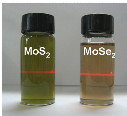
Рис. 3 – Фотографии дисперсий \text{MoS}_2 и \text{MoSe}_2 в ДМФА после центрифугирования
