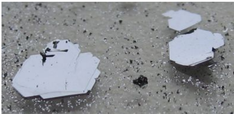
Рис. 2 – монокристаллы дисульфида молибдена 2H-MoS 2
