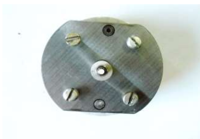
Рис. 2 – Пресс-форма в собранном виде
