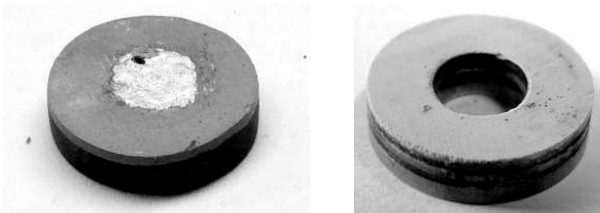
Рис. 3 – Опытные композитные образцы 2-х и 5-ти слойного сегнетомагнитного композита
