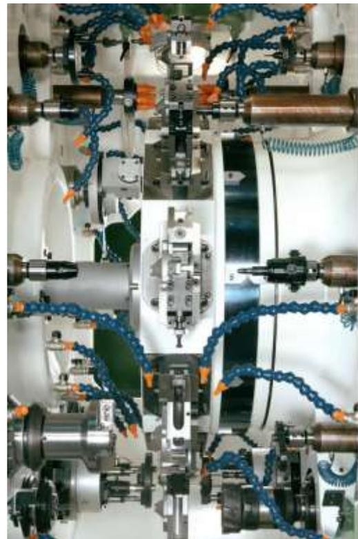
Рис. 5 – Общий вид поворотно-делительного барабана фирмы Porta Solutions
