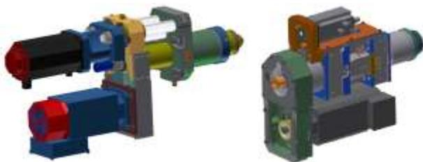
Рис. 6 – 3-D модель рабочего модуля с ЧПУ
