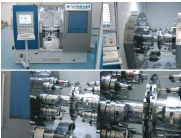
Рис. 12 – Компоновка агрегатного станка WINEMA RV20 Flexmaster
