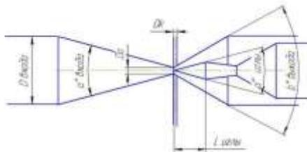
Рис. 10 – Фрагмент входа смесителя
