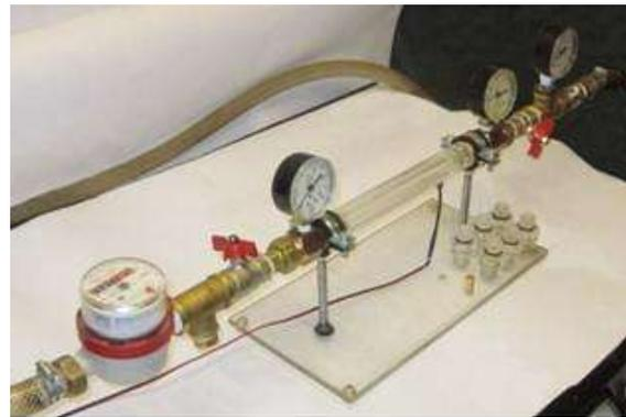
Рис. 4 – Стенд для испытаний кavitационных насадок
