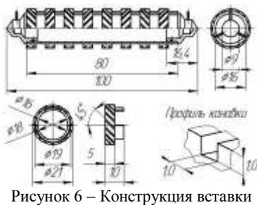
Рисунок 6 – Конструкция вставки
