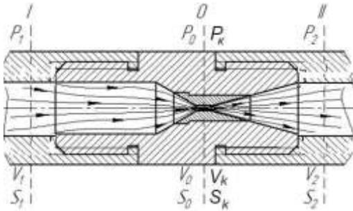
Рис. 1 - Схема течения жидкости в насадке
