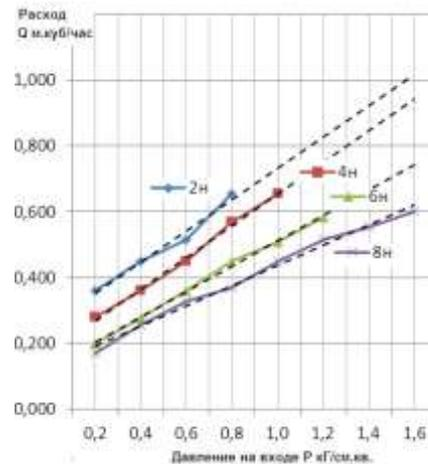
Рис. 8 - Изменение расхода при изменении давления на входе
