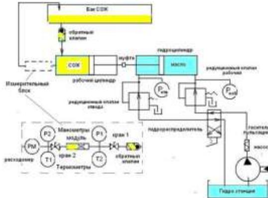
Рис. 3 – Стенд для испытания проточных активаторов
