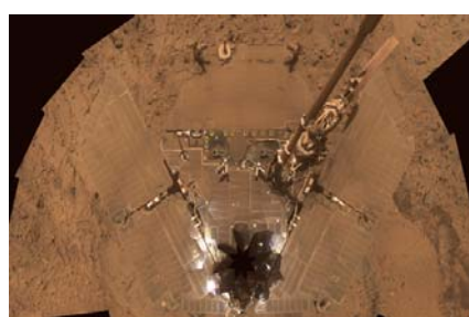
Рисунок 1.55 – Марсоходы: a - «Любопытство»; б, в – «Спирит» после песчаной бури с завязшими в глубоком песке колесами ( б ) и с покрытыми слоем песка ФСБ ( в )
