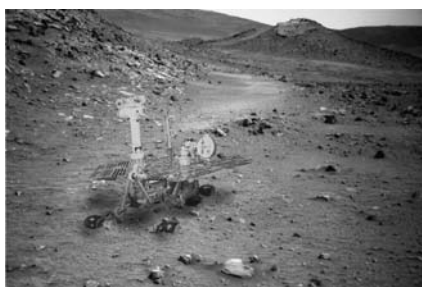
Рисунок 1.55 – Марсоходы: a - «Любопытство»; б, в – «Спирит» после песчаной бури с завязшими в глубоком песке колесами ( б ) и с покрытыми слоем песка ФСБ ( в )
