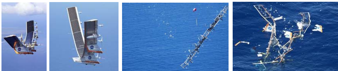
Рисунок 1.57 – Фазы входа солнечного самолета “Helios” в турбулентность (с потерей конструкционной устойчивости из-за сверхкритического флаттера крыла) и последующей гибели
