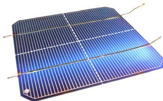
**Рисунок 1.2** - Монокристаллический кремниевый ФЭП серийного производства ПАО «Квазар» (г. Киев) с планарными размерами 12,5 см × 12,5 см (площадь фронтальной фотоприемной поверхности 156 см<sup>2</sup>), толщиной 170 мкм и КПД  $\approx 17\%$  для наземного применения
