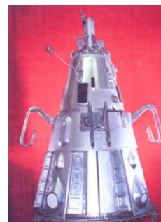
Рисунок 1.18 – Американский ИСЗ «Авангард-1» ( а : видны 4 мини-ФСБ) и третий советский ИСЗ «Спутник-3» ( б и на цветном фото справа: видна одна из четырех мини-ФСБ в верхней части корпуса)
