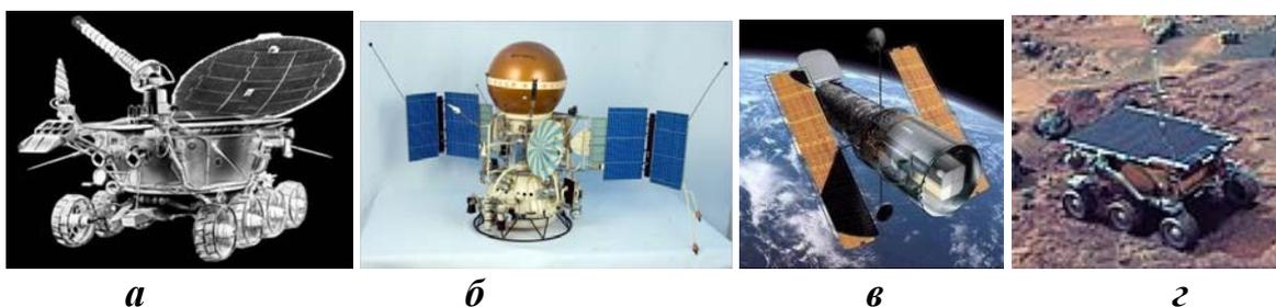
**Рисунок 1.27** – Солнечные батареи с арсенид галлиевыми ФЭП на некоторых космических аппаратах конца XX века
