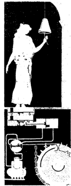
Автоматична система повороту статуї нереїди, яка відбиває склянки
