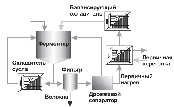
Рис. 3 – Схема установки теплообменников в процессе непрерывно-поточного метода ферментации
