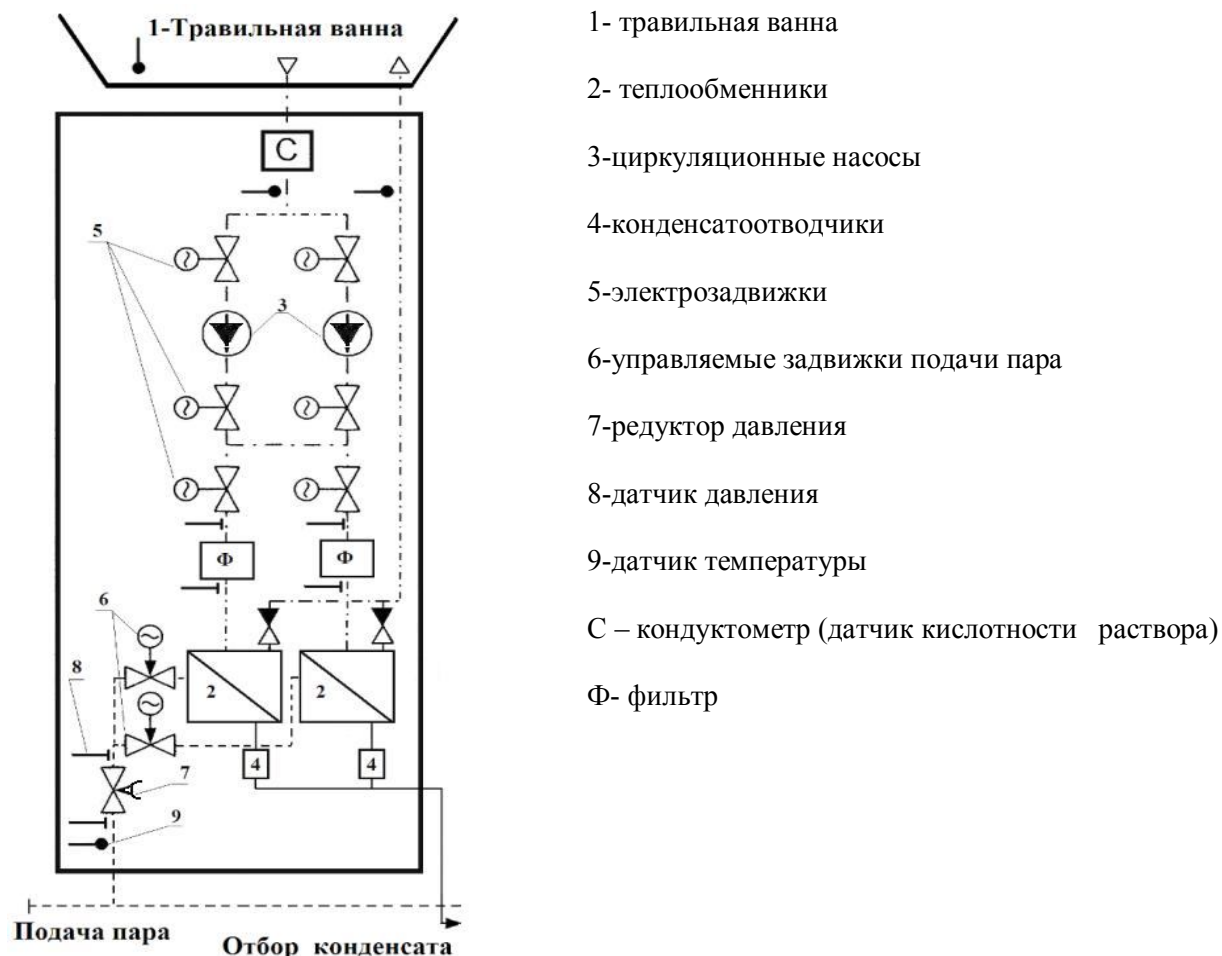
Рис.3.Принципиальная схема модуля нагрева травильного раствора
