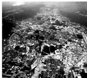
жённостью 27км, в центре которого при помощи 9300 магнитов в полном вакууме при температуре  $T = 2\text{K}$  пучки протонов разгоняются до околосветовых скоростей и сталкиваются между собой.
