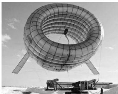
Немногим позже специалисты компании Altaeros Energies собираются произвести еще одни испытания установки AWT, во время которых она будет поднята на высоту более 300 метров, на высоту, где дуют в пять раз более сильные ветра, чем у поверхности. По предварительным расче-
