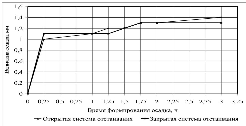
Рисунок – Динамика формирования осадка в закрытой и открытой системах отстаивания.
