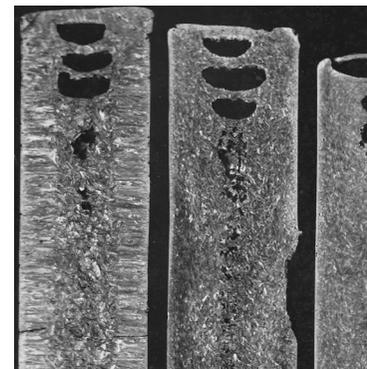
Рис. 1 Макроструктура камнелитых отливок а)  $M=2$ ; б)  $M=3$ ; в)  $M=4$ .
