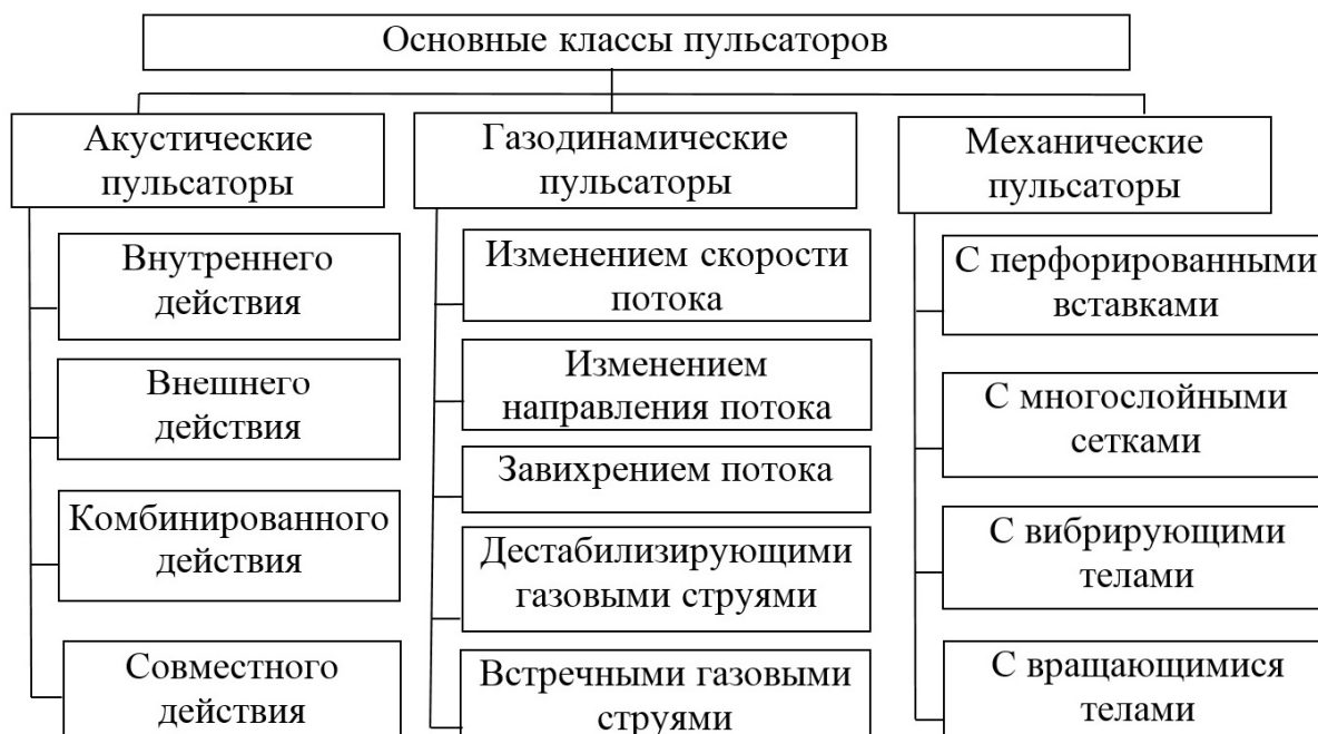
Рис. 1 – Классификация пульсаторов и принцип их реализации.
