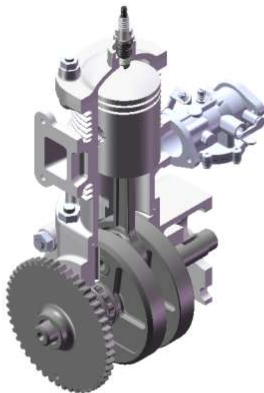
Рис 1. Пусковой ДВС П-350-2
