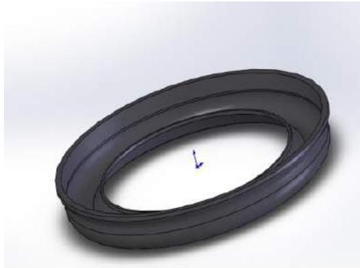
Рис. 2. – Гибкая оболочка в формате 3D, которая построена с помощью программы Solid Works
