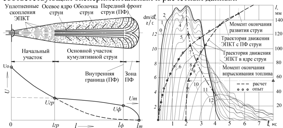
Рисунок 1 – Геометрическая интерпретация формирования и развития дизельной топливной струи.
