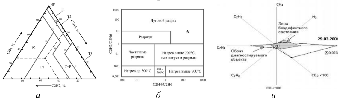
a – треугольник Дюваля; б – графический метод компании Electric Technology Research Association; в – лепестковая диаграмма
