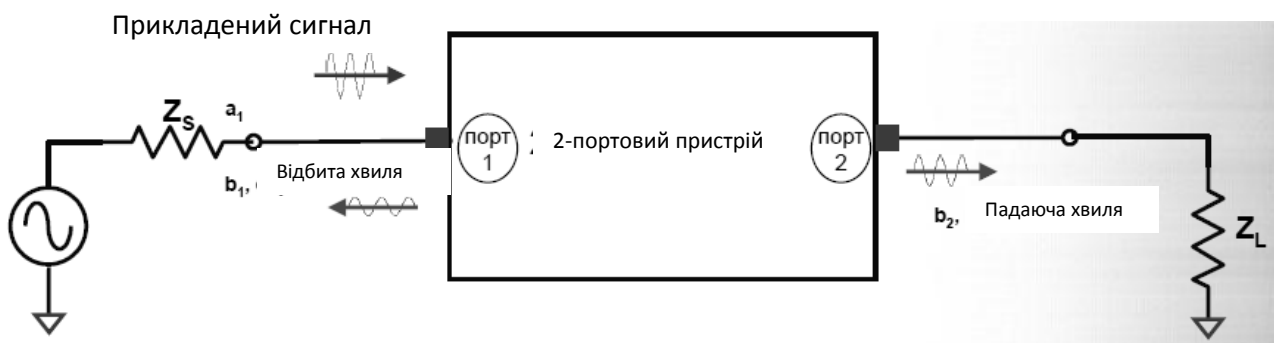
Рисунок – Схема визначення S-параметрів
