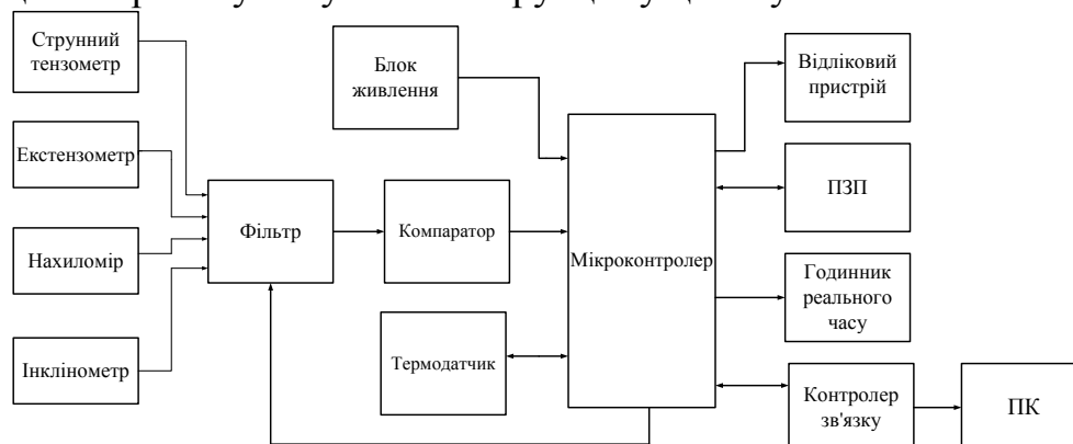
Рисунок 1 – Схема вимірювального пристрою для контролю технічного стану будівель та споруд
