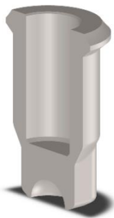
Рисунок 2-3D розріз гайки з підпором
