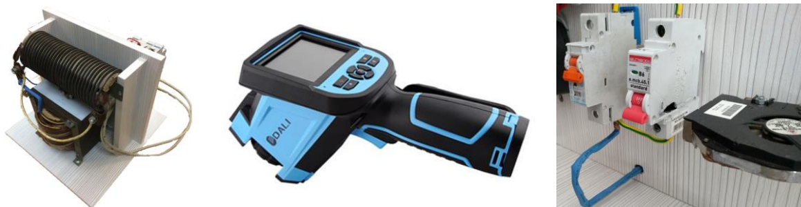
Рис. 2. Трансформатор з навантаженням, тепловізор та брейкер з штучною щілиною
