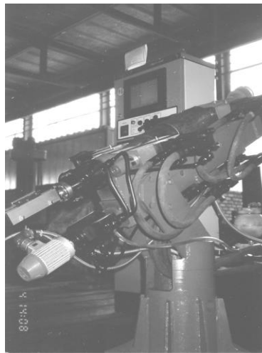
Рис.23. Стендове обладнання: 1 – силова основа; 2 – траверса; 3 - гідроциліндр верхнього захвата; 4 – гідроциліндр нижнього захвата; 5 – обертовий золотник, утворюючий синусоїдальний закон руху гідроциліндром переміщення; 6 – пристрій-вимірювач зусилля на штоці; 7 – пристрій-вимірювач переміщення.
