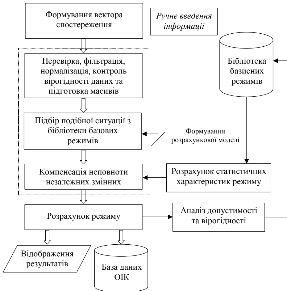
Рис. 3. Структурна схема організації розрахунку нормальних режимів ЕЕС у реальному часі в умовах неповноти початкової інформації
