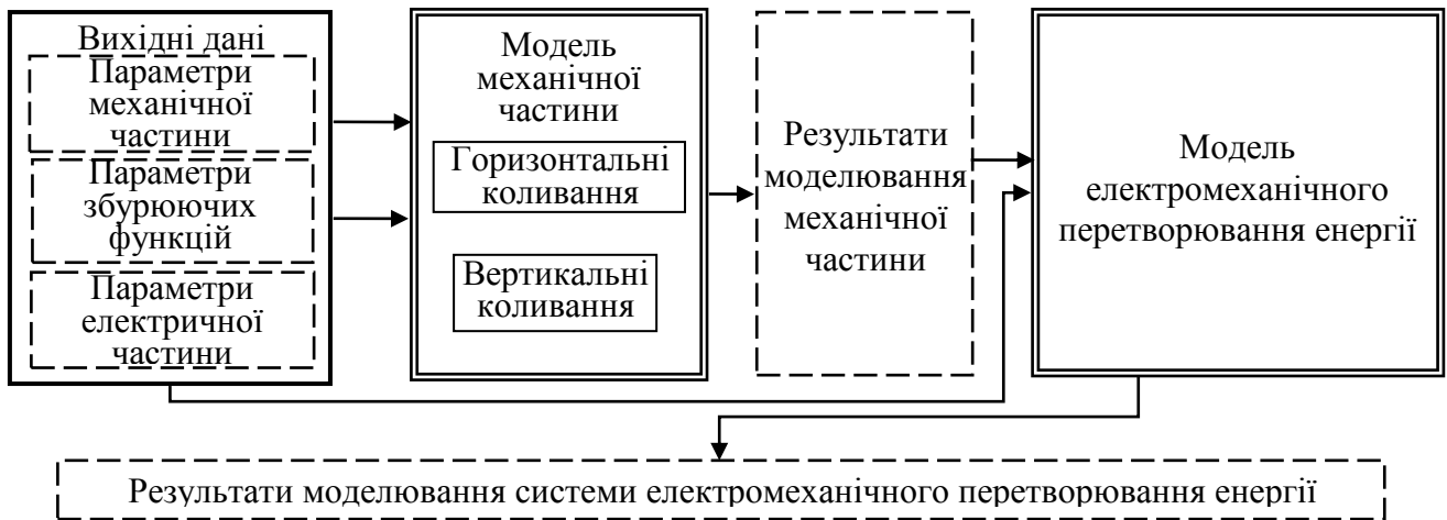
Рис. 1. Блок-схема програмно-алгоритмічного комплексу
