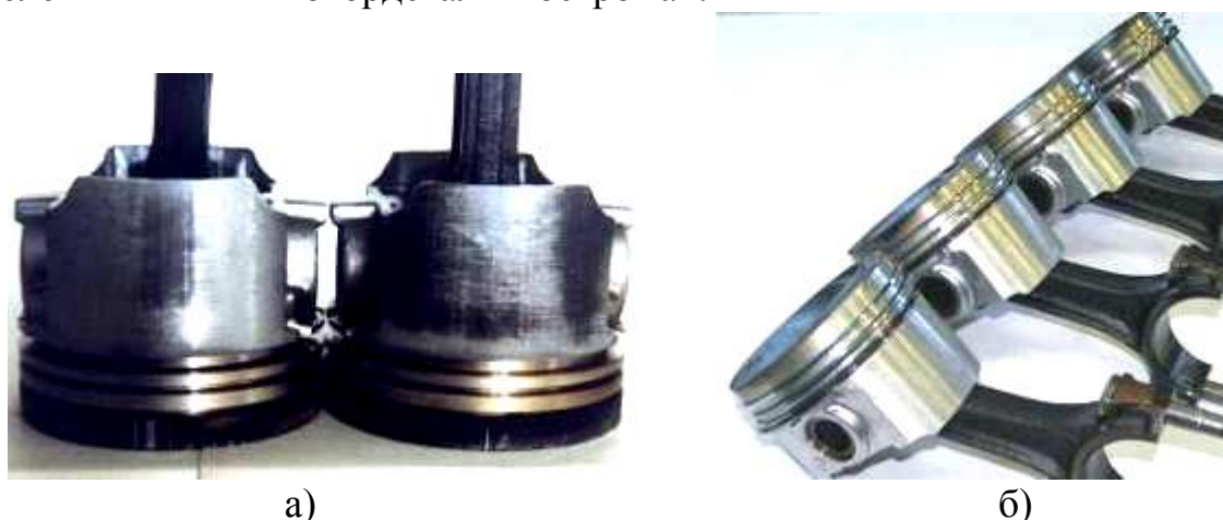
Рис. 22. Поршень 21083-1004015М після ресурсних (а) і прискорених випробувань (б)
