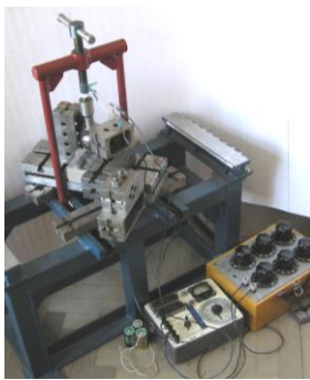
Рис. 33. Робочі моменти експериментальних досліджень кульового поршня та статора ГОП
