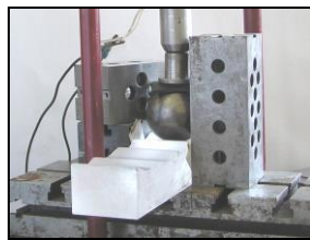
Рис. 33. Робочі моменти експериментальних досліджень кульового поршня та статора ГОП
