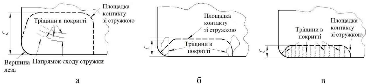
Рис.7. Схема утворення тріщин у плівковому покритті на передній поверхні інструменту при точінні сталі 45 з різними товщинами зрізу
