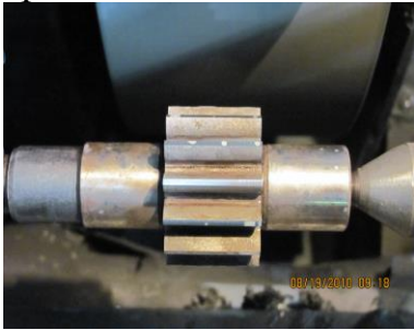
Рис. 15 Шліфування шестерень по зовнішньому діаметру для збільшення радіального зазору
