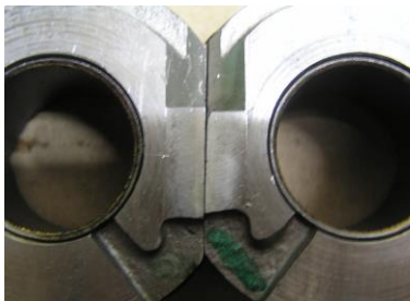
Рис. 18 Фотографія моделювання торцевого міжцентрового зазору шляхом фрезерування втулок у відповідній зоні
