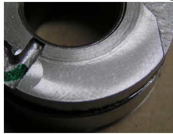
Рис. 19 Фотографії моделювання торцевого зазору в перехідній зоні НШ шляхом фрезерування втулок у відповідній зоні
