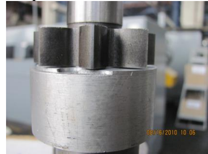
Рис. 17 Фотографія качаючого вузла НШ-32УКФ-3, укомплектованого експериментальною втулкою зі сходиною для моделювання торцевого зазору
