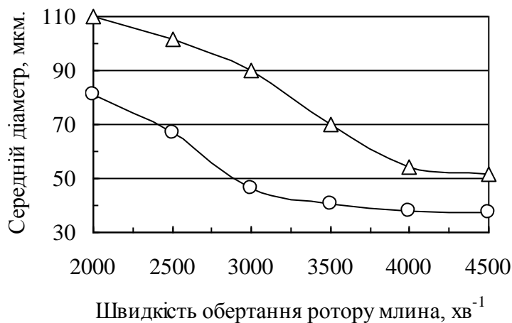
Рис. 1. – Залежність середнього розміру подрібнених часток від швидкості обертання ротору млина, термооброблених за участю \text{H}_2\text{O} ( \Delta ) і охолоджувальної суміші на основі \text{AlCl}_3 \cdot 6\text{H}_2\text{O} ( \circ ).
