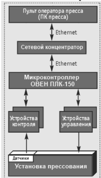
Рис. 7. Структурна схема системи управління
