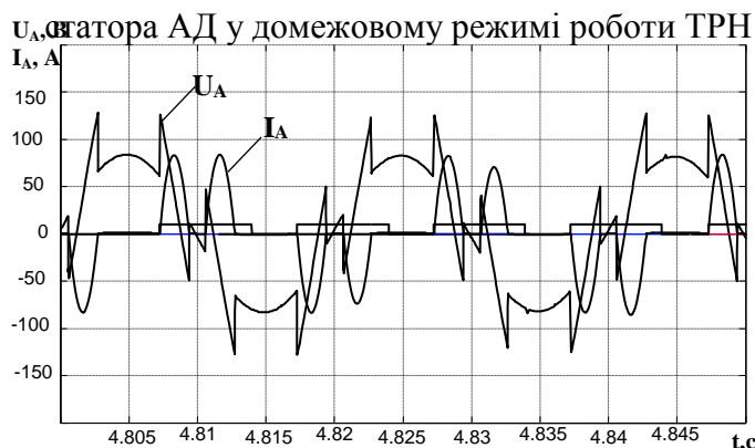
Рис. 10. Часові діаграми струму і напруги фази А
