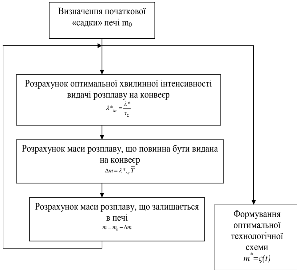
Рис. 6. Процедура формування оптимальної технологічної схеми плавки
