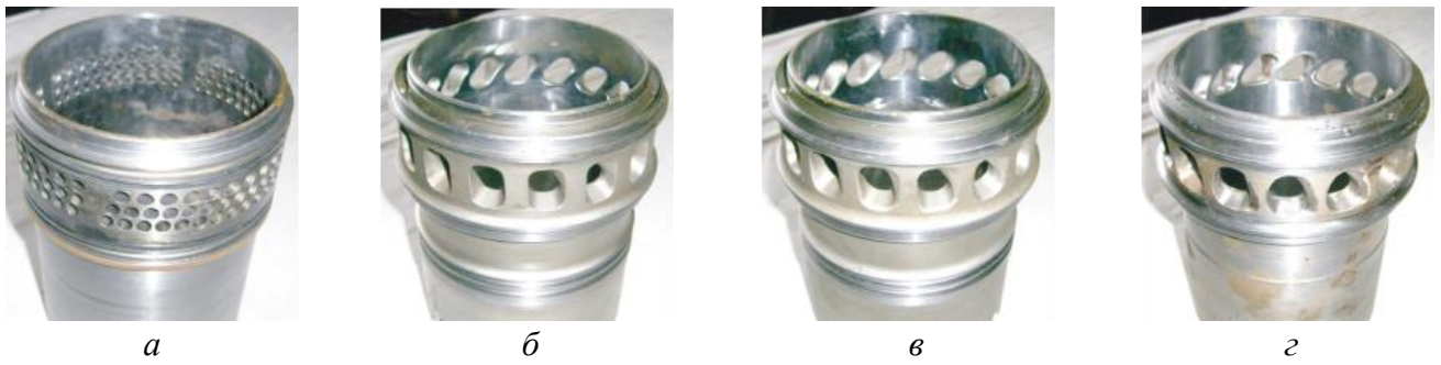
Рис. 4. Впускні вікна на гільзах циліндрів дизелів:
