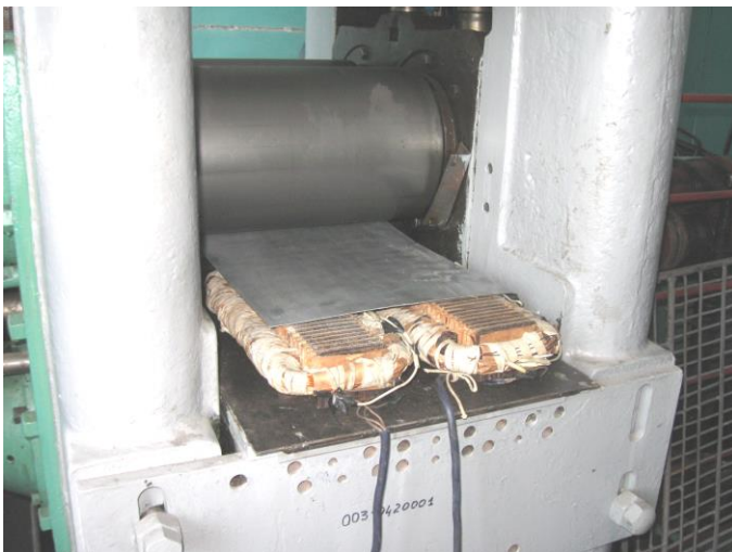
Рис. 24. Випробування системи керування формою штаби на прокатному стані
