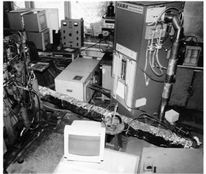
Рис. 7. Принципова схема та загальний вигляд мінітунелю МТ-1
