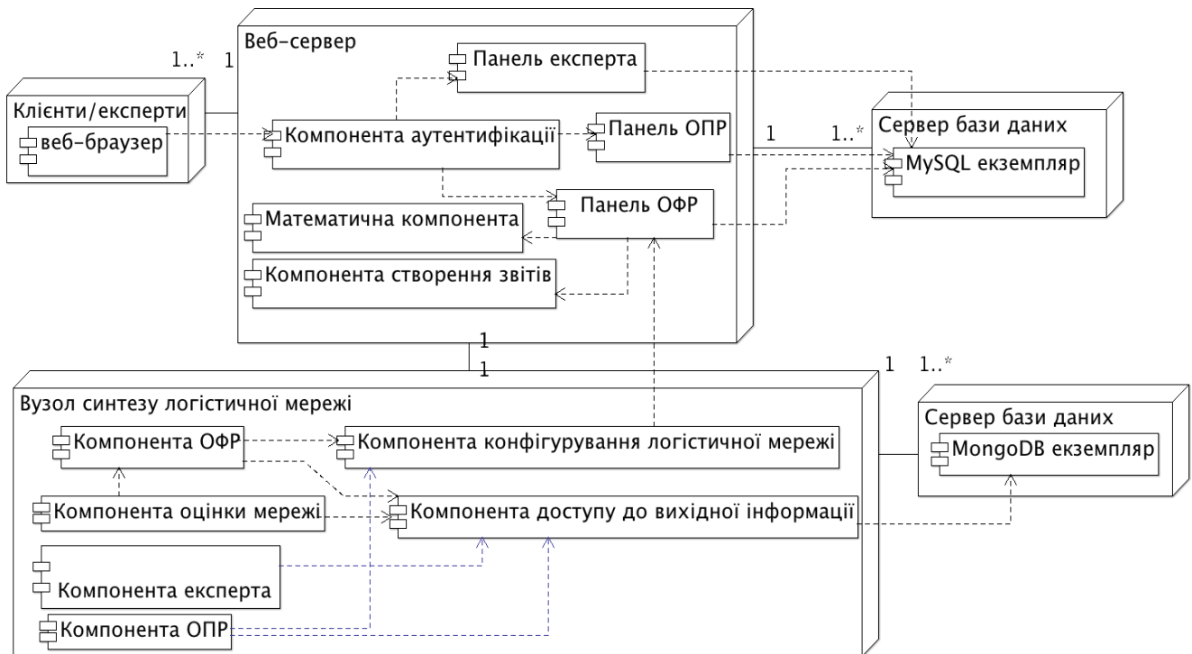
Рисунок 4 – Діаграма розміщення функціональних блоків КЛС і формування ОССУ
